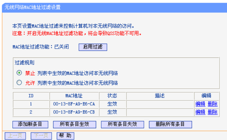
图 5-26 无线网络 MAC 地址过滤设置
