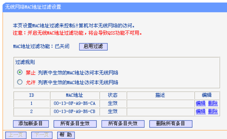
图 5-15 无线网络 MAC 地址过滤设置
