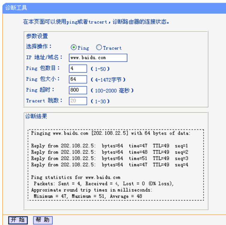
图 5-72 Ping 诊断结果—成功
