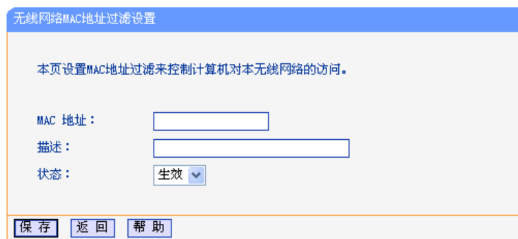
图 5-16 无线网络 MAC 地址过滤设置
