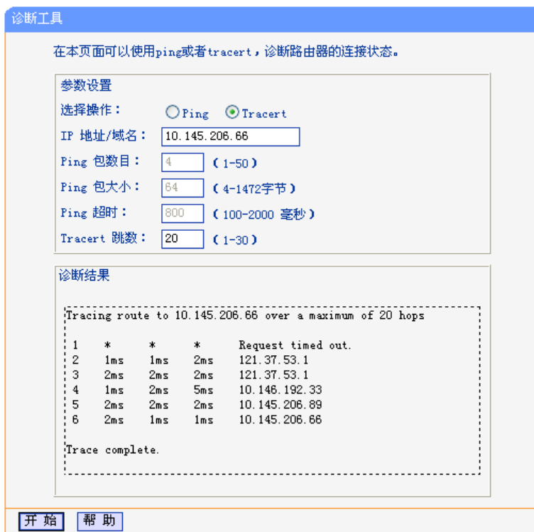
图 5-74 Tracert 诊断结果—成功
